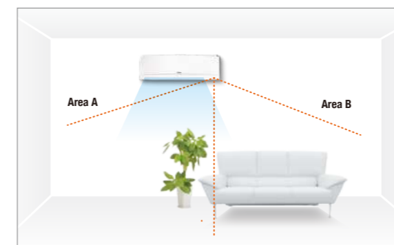
Jika tidak ada seseorang yang terdeteksi baik Area A atau B selama 20 menit, Sensor mata otomatis menyesuaikan suhu yang disetel.
