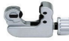
Alat Pemotong Pipa (S) - TA560NT Untuk ukuran pipa 3/16 ~ 1 1/4 Dapat memotong pipa dengan ketebalan kurang dari 3 mm
