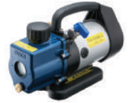
Pompa Vakum Dua Tahap - TA150SW-EXP Type Rotor : 2 Tahap Kapasitas pemindahan : 1.4CFM (40L/Mnt) Kekuatan Vakum : 38 Micron (220V, 200W) Putaran per menit : 3.200 Rpm Kapasitas Oli : 140 ml Ukuran : 10 x 26 x 17 cm (4,3 Kg) – termasuk adapter (5/16 & 1/4)
