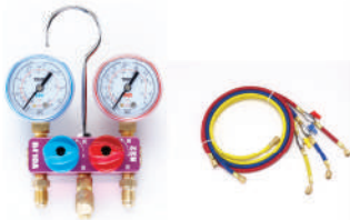
Mini Manifold + Selang - TA122MB-1-EXP Diameter Gauge 50 mm Ukuran sambungan 5/16 Tekanan Normal 750 PSI Skala suhu saturasi untuk R410A/R32 Memiliki fungsi adjustment
