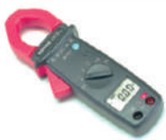
Tang Amper - TA451D-2 Type Deteksi : RMS Kemampuan Dekomposisi : 0.01 Ma Diameter Penjepit : Max 40 mm Respon Frekuensi : 20 – 1 KHz Power : AC 300V Battery : AAA R03 1.5V Size & Weight : 185 x 81 x 32 – 270g
