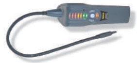
Pendeteksi Kebocoran - TAS00039 Type Refrigerant : R410A, R407, R404, R134, R22, R32, etc Sensitivitas : 3g/yr (Hi), 20g/yr (Mid) & 40g/yr (Lo) R410A Alarm Deteksi : Buzzer dengan 7 level LED warna Waktu Pemanasan : 45 Detik Temperatur saat bekerja : 0–40o C, Hum >80% Battery : C-Cell x 2 Adaptor Ukuran : 22.2 x 66 x 51 (bonus tas)
