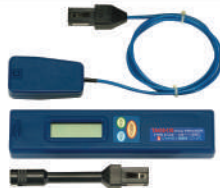
Thermometer Digital - TA410AB Kapasitas pengukuran -50o ~ 1.200oC Jarak ukuran Sensor -50o ~ +200oC Presisi indikasi : Jarak Error (0,5% rdg +1dig) Koefisien temperatur (+0,04% of FS/C) Siklus sampling : 3 kali / detik Pengaturan pemakaian : POWER, HOLD, MODE Battery Life >100 Hours (006p)
