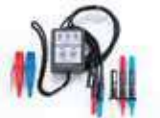
Phase Checker - TAS0026 Tegangan spesifikasi: 3-fase 200 hingga 480 VAC Waktu penggunaan berkelanjutan: 200V = dalam 60 menit, 480V = dalam 4 menit Rentang frekuensi: 20-400Hz Menahan tegangan: AC4000V / 1 menit
