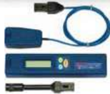
Thermometer Digital - TAS00017 Kapasitas pengukuran -500 ~ 1.200oC Jarak ukuran Sensor -50o ~ +200oC Presisi indikasi : Jarak Error (0,5% rdg +1dig) Koefisien temperatur (+0.04% of FS/C) Siklus sampling : 3 kali / detik Pengaturan pemakaian : POWER, HOLD, MODE Battery Life >100 Hours (006p)
