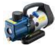
Pompa Vakum Dua Tahap - TAS00012 Type Rotor : 2 Tahap Kapasitas pemindahan : 1.4CFM (40L/Mnt) Kekuatan Vakum : 38 Micron (220V, 200W) Putaran per menit : 3.200 Rpm Kapasitas Oli : 140 ml Ukuran : 10 x 26 x 17 cm (4,3 Kg) – termasuk adapter (5/16 & 1/4)
