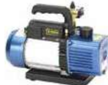
Pompa Vakum VRV - TAS0090 Type Rotor : 2 Tahap Kapasitas pemindahan : 9.5CFM (270L/Mnt) Kekuatan Vakum : 12 Micron (220V, 200W) Putaran per menit : 3.440 Rpm Kapasitas Oli : 570 ml Ukuran : 38 x 16 x 28,5 cm (14,8 Kg) – termasuk adapter (1/4 & 5/16)
